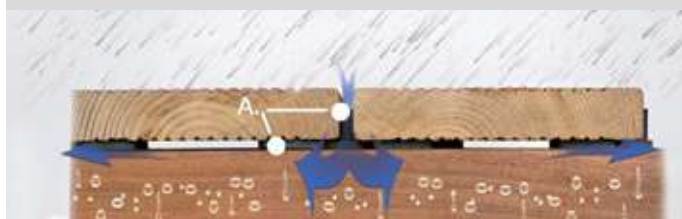
A. Entretoise d'assemblage, pas de stagnation d'eau.
