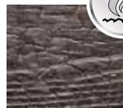
**Surface carbonisée :** La carbonisation contrôlée des surfaces en bois crée un parement carbonisé qui offre une multitude d'aspects selon les structures et le grain des bois.
