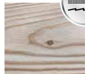
**Surface brossée :** La surface préalablement rabotée est travaillée de manière intensive à l'aide de brosses. Les bois tendres comme l'épicéa possèdent des cernes de croissance tendres et durs qui se creusent en fonction de la dureté du bois lors du brossage, on obtient une surface « ondulée » accentuant bien la structure du bois.
