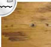
**Surface éclatée :** Rabotée au préalable, la surface est alors lentement travaillée à l'aide de multiples couteaux, lentement et tout en surface. Ce principe s'apparente au traitement ancestral appliqué jadis pour équarrir les poutres; il confère au bois un caractère rustique bien particulier.
