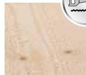
**Surface sciée fin :** Le bois re-fendu à la scie à ruban présente une surface brute de sciage. Par un procédé de brossage répété et minutieux, les fibres de bois détachées sont partiellement éliminées pour garantir une qualité optimale de la surface des profilés, cela afin d'offrir le meilleur support à toute finition.
