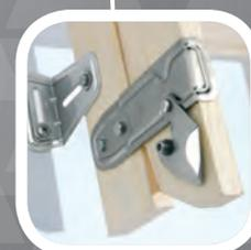
Grâce au mécanisme spécialement conçu, les segments sont libres de glisser l'un par rapport à l'autre. Le segment le plus long se déplace vers le bas en créant une échelle stable. Pendant la fermeture de l'escalier, ce segment glisse vers le haut et se cache finalement au grenier.
