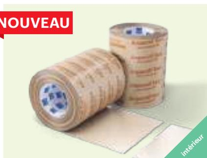
Patchs d'étanchéité acryliques à base de papier pour le collage rapide d'ouvertures plus grandes comme les ouvertures d'insufflation, sur des surfaces lisses en aménagement intérieur sec. Le revêtement spécial permet une pose directement à partir du rouleau, sans pellicule.
