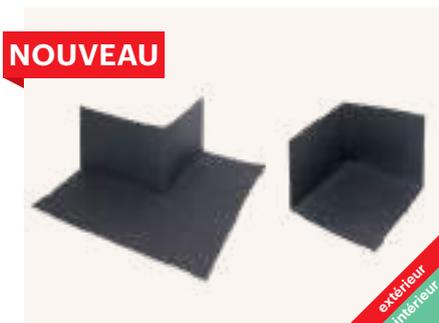
Coins intérieurs et extérieurs autoadhésifs préfabriqués pour la réalisation rapide d'un raccord souple durablement étanche au vent ou à l'air, par ex. pour les fenêtres, les portes, etc. Matériau de support composite non tissé, résistant aux UV, pour l'extérieur.
