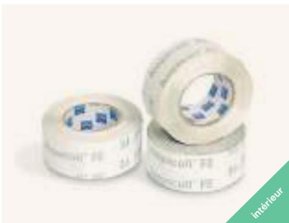
Colle acrylique filamenteuse modifiée, appliquée sur un papier en fibres de synthèse. Bande adhésive avec zone intermédiaire exempte de colle et film séparé enlevable en PE résistant à la déchirure. La bande adhésive idéale pour le collage hermétique des joints de fenêtres, joints d'angle et raccords de panneaux.
