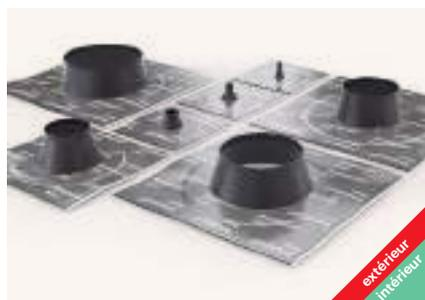
Manchettes permettant de réaliser des étanchéités au radon sur les pénétrations circulaires dans le bâtiment; pour un usage en intérieur et en extérieur (Sécurisation par collier de serrage nécessaire). Ces manchettes se composent d'une pièce moulée en EPDM, intégrée à une bride en aluminium dotée d'une surface adhésive en butyle.
