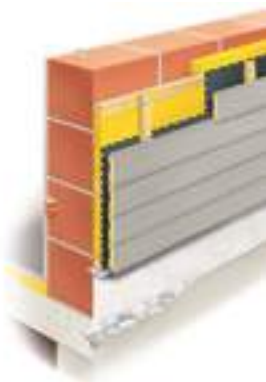
Structure d'un mur en construction en dur.
