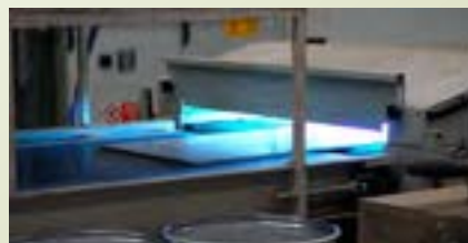
3. Die geschliffenen Platten werden weiss geprimert und mit einem neuen Dessin bedruckt 3. Les panneaux poncés sont apprêtés en blanc et imprimés avec un nouveau dessin
