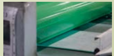
4. Korus- oder HotCoating-Beschichtung 4. Revêtement Korus ou HotCoating
