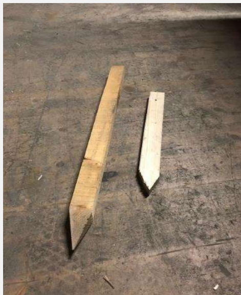
Piquets de marquage
